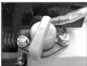
Рис. 12 Установка выключателя зажигания
